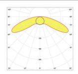
Avec optique à faisceau large. Lumière uniforme jusqu'à 14m de large à 3m de hauteur d'installation.
